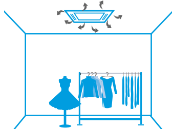
Rozkład powietrza z zabrudzonym filtrem
