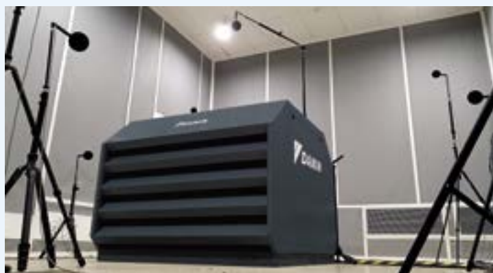
Pomiar poziomu mocy akustycznej w komorze akustycznej
