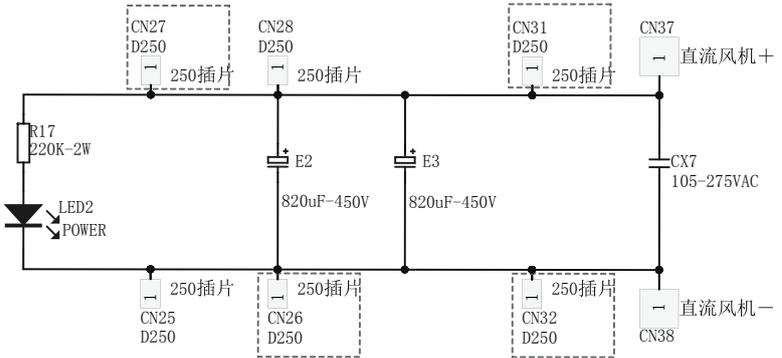
注：CN37 焊接到CN40, CN38 焊接到CN41
