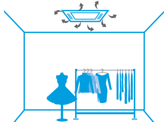
Rozkład powietrza z zabrudzonym filtrem
