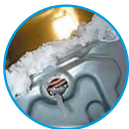
Obieg czynnika chłodniczego dolnej płyty wymiennika ciepła
