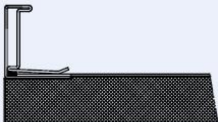
Izolacja cieplna wewnętrzna kauczukiem samoprzylepnym
