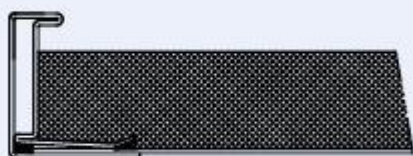
Izolacja cieplna zewnętrzna kauczukiem samoprzylepnym
